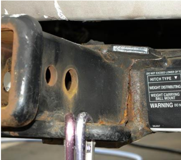
연결장치 변형 및 손상
